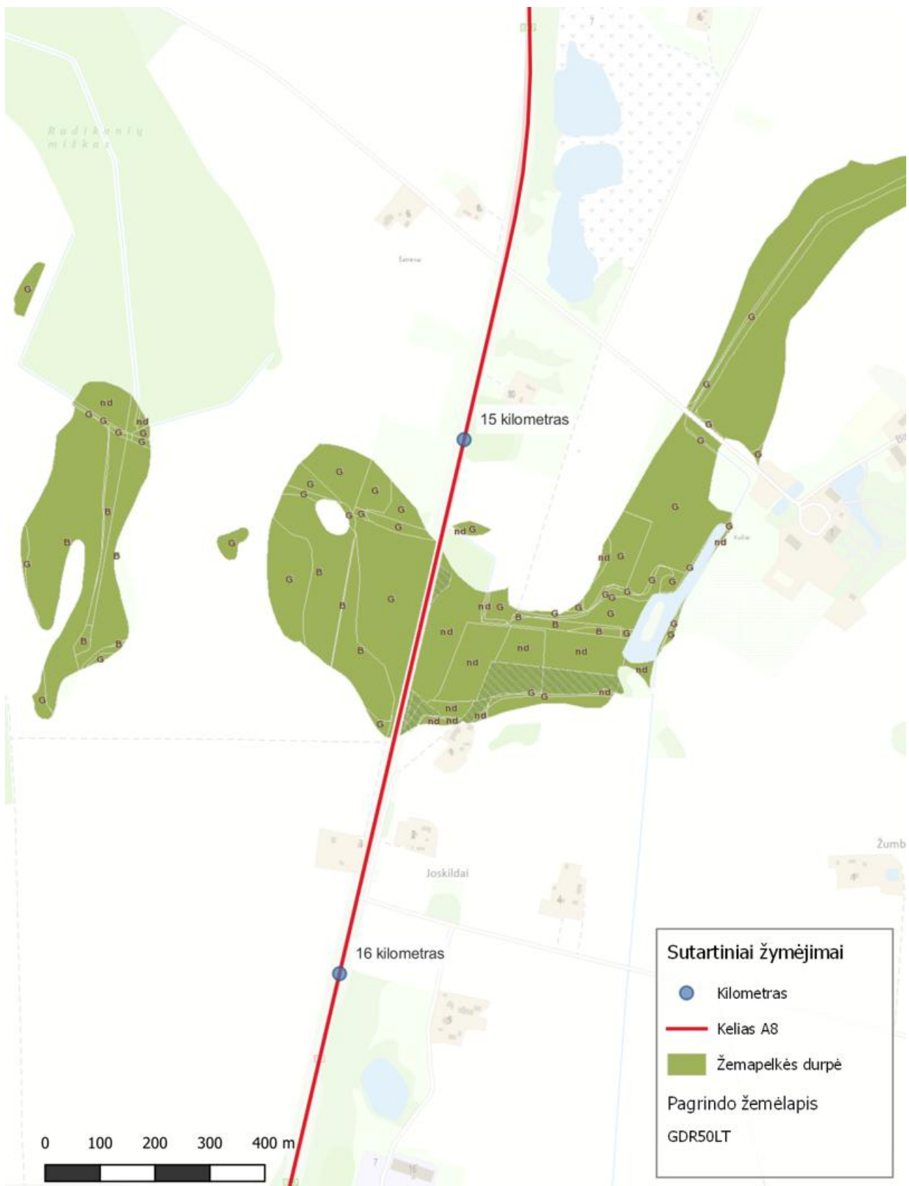
4 pav. Lietuvos pelkių ir durpynų duomenų rinkinio (LGF 2018 m. vertinimas) ištrauka ties kelio A8 15–16 kilometru
