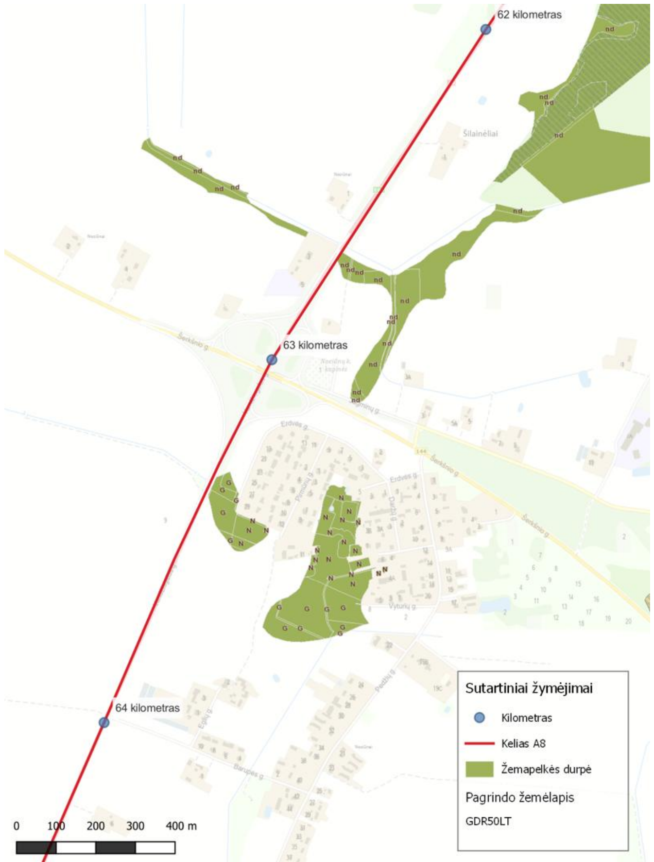
19 pav. Lietuvos pelkių ir durpynų duomenų rinkinio (LGF 2018 m. vertinimas) ištrauka ties kelio A8 62–64 kilometru
