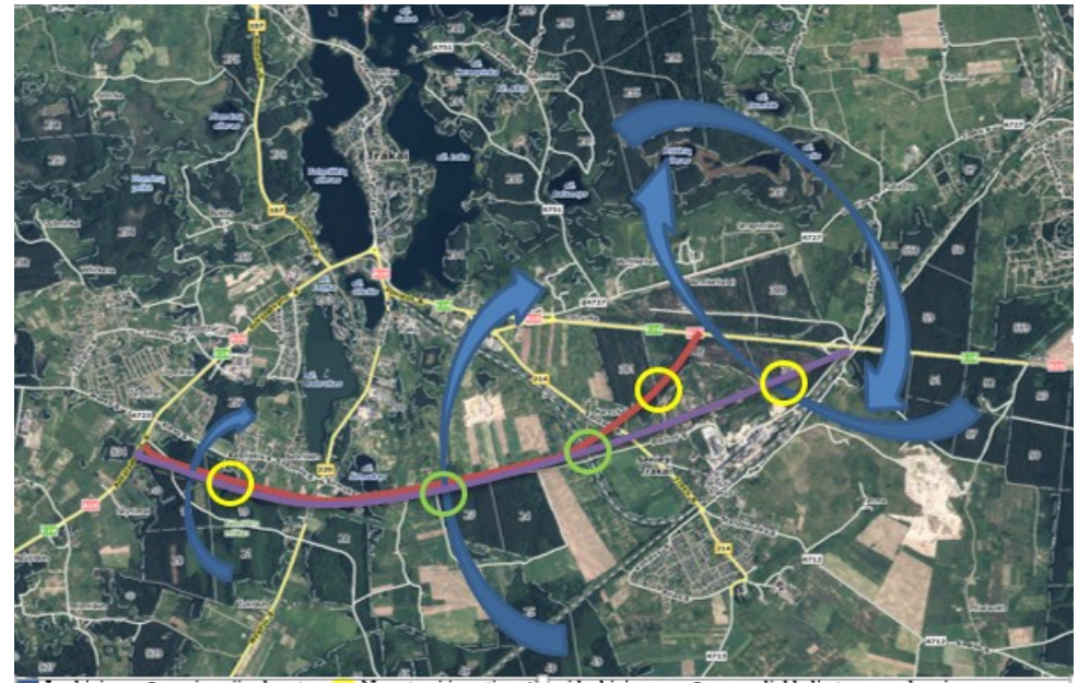
Laukinių gyvūnų migracijos kryptys, ● Numatomi įrengti praėjimai laukiniams gyvūnams aplinkkelio trasos sankasoje, ● Teritorijos, numatomos pritaikyti laukinių gyvūnų migracijai
